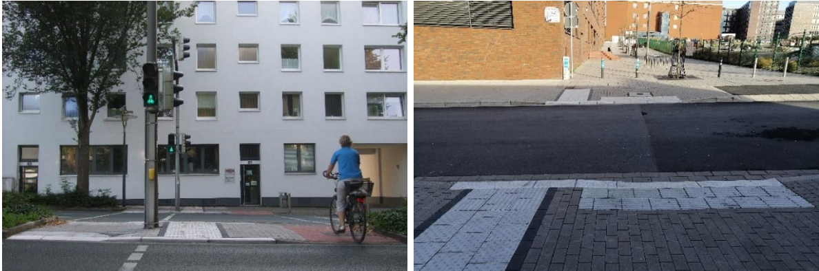
Abbildung 4: Differenzierte Bordhöhe mit Nullabsenkung und 6 cm Bord
